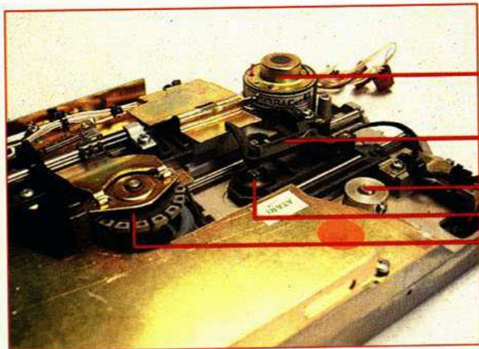
Bild 8. Das Innenleben des Atari 1050 Laufwerks
